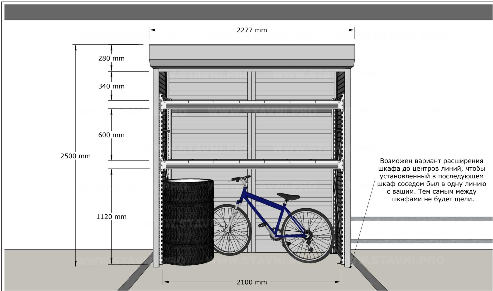
Возможен вариант расширения шкафа до центров линий, чтобы установленный в последующем шкаф соседом был в одну линию с вашим. Тем самым между шкафами не будет щели.
